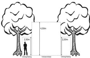
Als „Lichttraumprofil“ wird eine definierte Umgrenzungslinie bezeichnet, die meist für die senkrechte Querebene eines Fahrweges bestimmt wird. Aus Gründen der Sicherheit und Leichtigkeit des Verkehrs muss das Lichttraumprofil der öffentlichen Verkehrsflächen frei und sauber gehalten werden.
